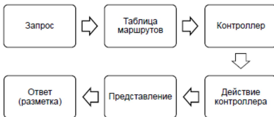
Рис.2. Схема обработки запросов MVC – приложения
