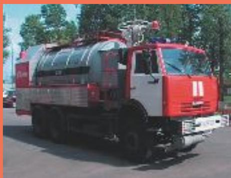
**Автомобиль газового тушения «АГТ 4000» предназначен для тушения локальных пожаров на атомных электростанциях, переливочных пунктах, складах ГСМ, газопроводах, в подземных коллекторах**
