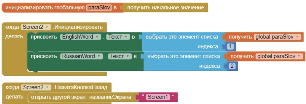
Рисунок 274. Общий вид программных блоков второго экрана приложения.
