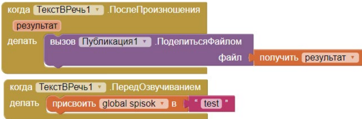
Рисунок 166. Пред- и постобработчики компоненты ТекстВРечь
