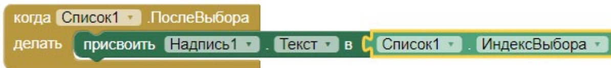
Рисунок 161. Вывод индекса выбранного элемента списка
