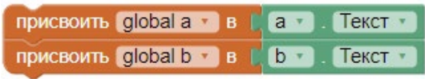
Рисунок 124. Инициализация переменных значениями текстовых полей
