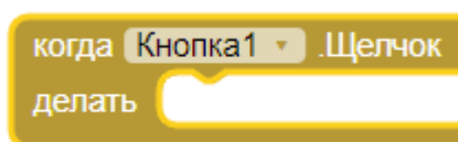
Рисунок 93. Обработчик события нажатия на Кнопку1
