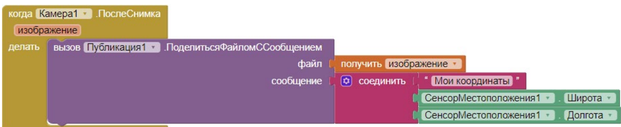
Рисунок 288. Обработчик результатов съёмки
