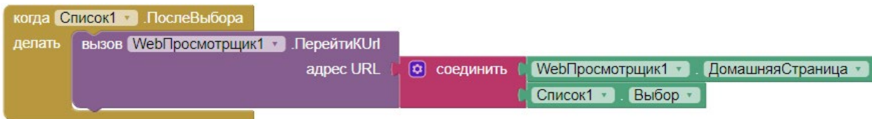
Рисунок 224. Обработка события выбора элемента списка
