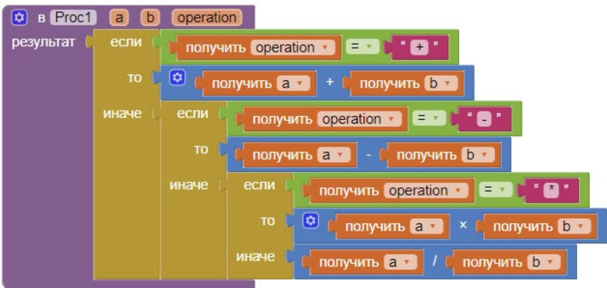
Рисунок 130. Представление операций калькулятора через процедуру
