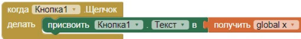
Рисунок 71. Присвоение тексту кнопки значения глобальной переменной x
