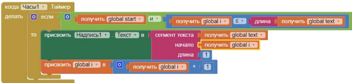
Рисунок 119. Финальная схема блоков обработчика таймера
