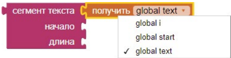
Рисунок 112. Блок получения сегментов текста
