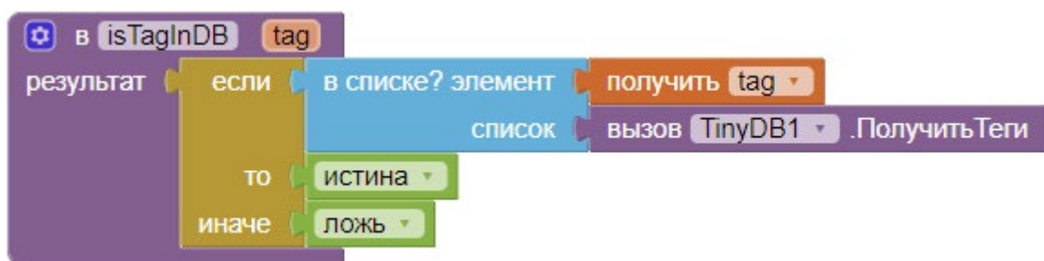
Рисунок 300. Блок проверки существует ли ключ в базе.
